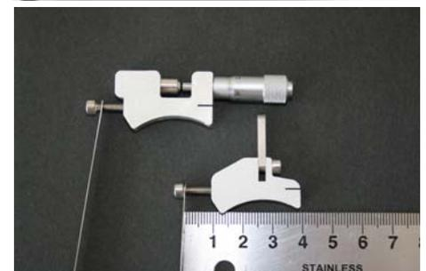
Setzen Sie nun den Messaufsatz auf das Objektiv entweder auf den feststehenden Teil mit der Tiefenschärfescala oder auf den beweglichen Teil mit der Meterscala.
