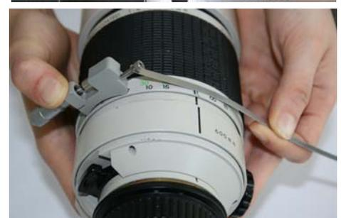
Legen Sie nun das Stahlband eng um das Objektiv und markieren Sie es an dem Schlitz des Messaufsatzes.
