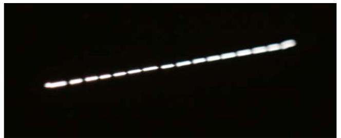
Bei Analogkameras sollte die Messreihe gleich sehr fein sein, da die Aufnahmen erst entwickelt werden müssen. Es ist zweckmäßig, mehrere Reihen aufzunehmen.
