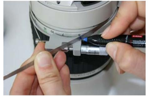
Schneiden Sie ca. 5mm hinter der Markierung das Stahlband ab. Sollte es sich an der Schneidstelle verformen, klopfen Sie es wieder gerade.
