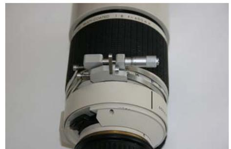
Stellen Sie nun den Messblock auf 3mm ein und legen Sie die Mitnehmerlasche ein. Dazu drücken Sie die Kugel des Messblocks etwas zurück. Anschließend wird die Mitnehmerlasche mit der Schraube fixiert.
