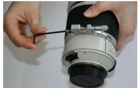
Montieren Sie nun den Verstellaufsatz gegenüber dem Messblock in der selben Art und Weise.
