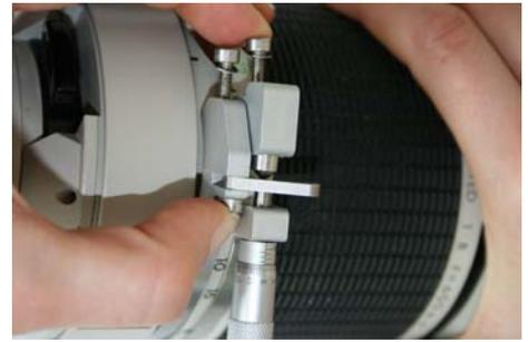
Kontrollieren Sie den Rohfokus und fixieren Sie den FixFokus durch Anziehen der Inbusschrauben.
