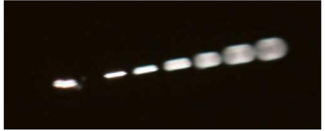
Zur Testaufnahme wird die Kamera ohne Nachführung auf eine Region nahe dem Himmelsäquator ausgerichtet. Kamera auf Dauerbelichtung einstellen und auslösen. Alle ca. 10 Sekunden wird die Belichtung mittels „Hutmethode“ unterbrochen und ein neuer Fokuswert eingestellt. Die letzte Belichtung sollte mindestens doppelt so lang sein, um die Reihenfolge der Testreihe festzulegen.
